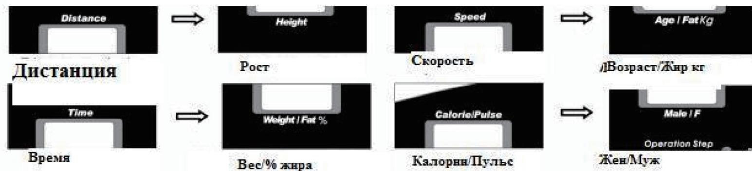
Прежде чем перейти к измерению, введите Ваши показания веса, роста, возраста и пола. После чего нажмите Старт и удерживайте руки на пульсометре. Спустя 5 секунд на дисплее отобразятся показания Жира в кг и в %. При возникновении ошибок, на экране отобразится E-03
